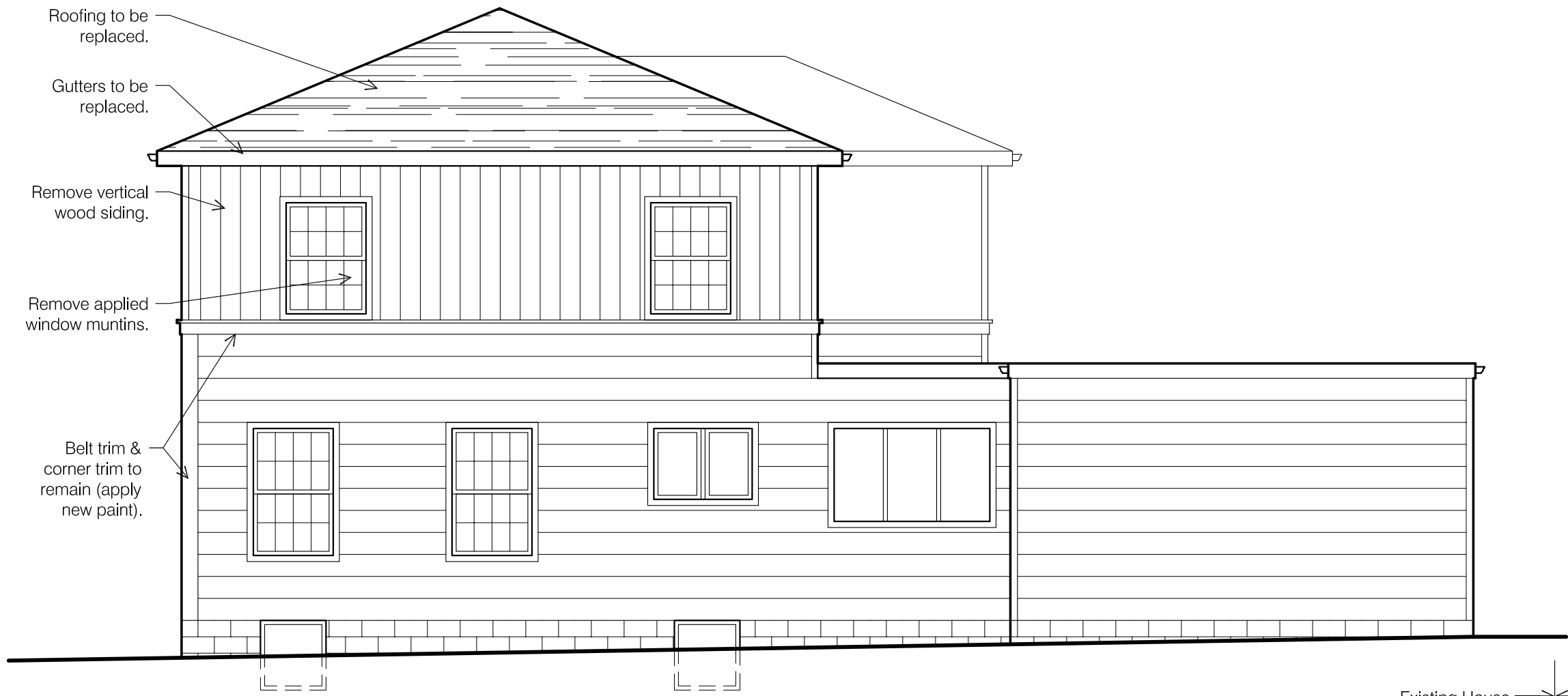
D1 WEST DEMO ELEVATION SCALE: 3/16" = 1'-0"
