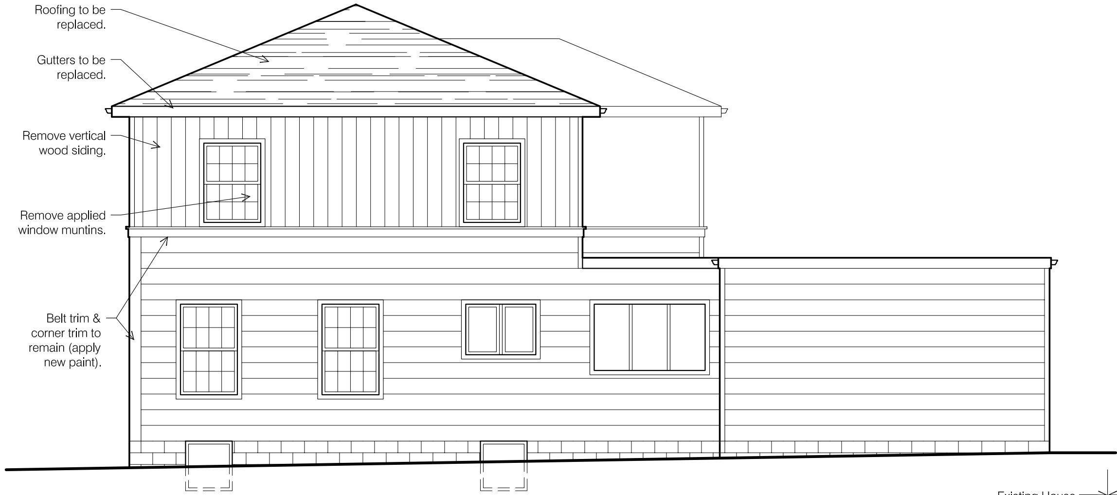
D1 WEST DEMO ELEVATION SCALE: 3/16" = 1'-0"
